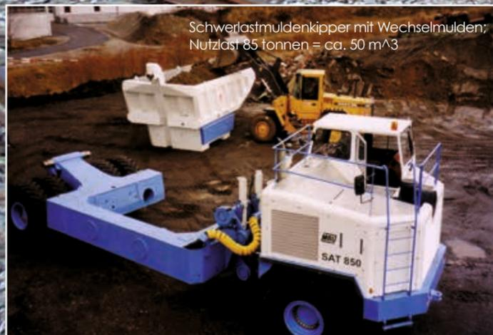
Schwerlastmuldenkipper mit Wechselmulden;
