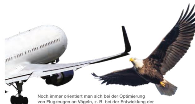
Noch immer orientiert man sich bei der Optimierung von Flugzeugen an Vögeln, z. B. bei der Entwicklung der Winglets, der Wölbungen an den Flügelspitzen.
