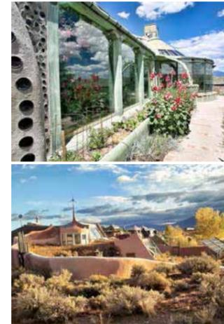
Ein Earthship ist ein passives Solar-Haus welches aus natürlichen sowie aus Recycling-Materialien, wie z.B. mit Erde gefüllten, alten Autoreifen oder alten Flaschen gebaut wird.
