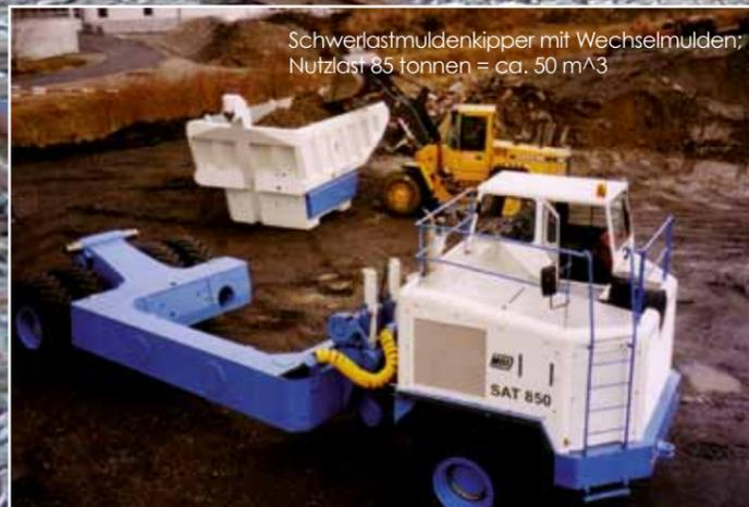
Schwerlastmuldenkipper mit Wechselmulden;
