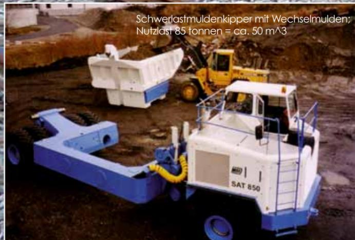
Schwerlastmuldenkipper mit Wechselmulden;
