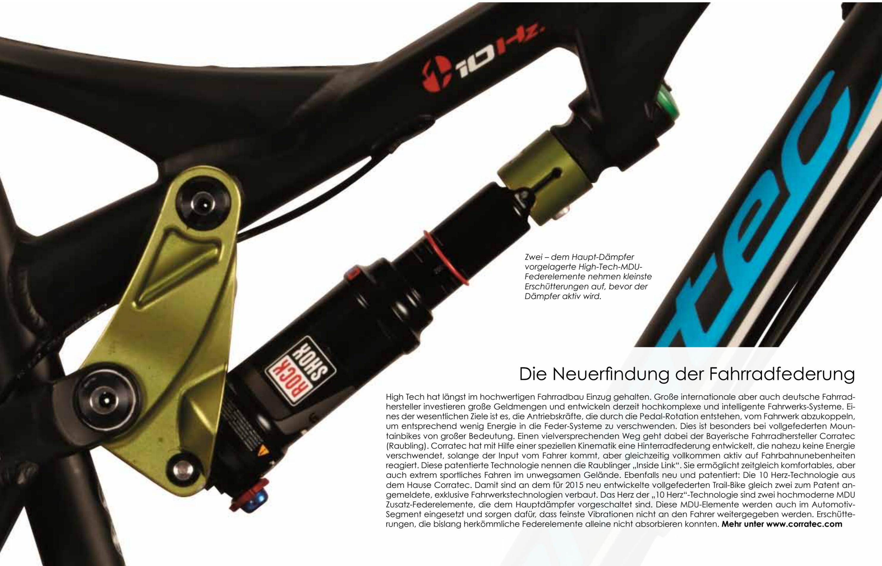
*Zwei – dem Haupt-Dämpfer vorgelagerte High-Tech-MDU-Federelemente nehmen kleinste Erschütterungen auf, bevor der Dämpfer aktiv wird.*
