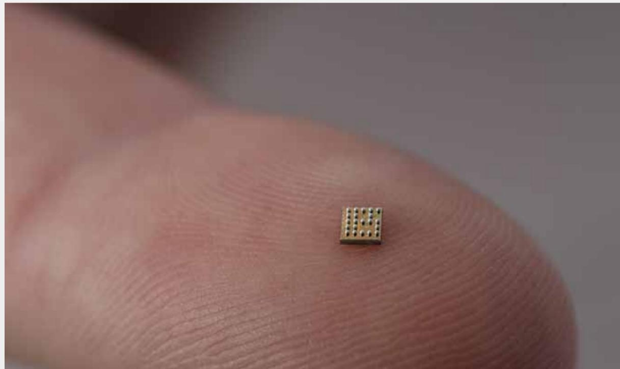
CompoTEKs Partner EM Microelectronic hat gemeinsam mit der Swatch Group R&D und dem CSEM, ein Forschungs- und Entwicklungszentrum mit den Schwerpunkten Mikro- und Nanotechnologie, den nach eigenen Angaben weltweit kleinsten Bluetooth Chip entwickelt. Er besteht aus mehr als 5 Millionen Transistoren auf einer Fläche von nur 5mm<sup>2</sup> und ist bereits die neue Bluetooth Version 5.0 Standard qualifiziert.
